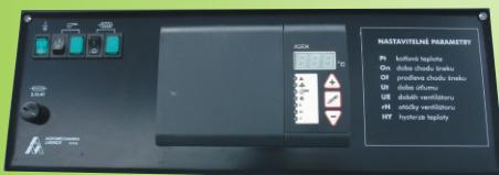
Regulátor je řešen jako procesorový s analogovým čidlem teploty a releovými výstupy pro ventilátor, šnekový podavač paliva a čerpadlo kotlového okruhu. Na displeji lze odečítat kotlovou teplotu a nastavené parametry.
