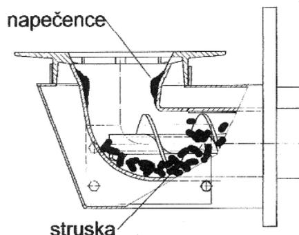
vzduchu. Po vypnutí hořáku odšroubujeme víčko čištění směšovače a nečistoty vyhrabeme. Při čištění kotle může po delší době provozu dojít také k uvolnění kruhového roštu – vydrolení těsnícího tmelu – což se projeví podobně jako zanesený směšovač, protože vzduch „utíká“ mezi roštem a kruhovým nadstavcem směšovače. Proto je nutné dosedací plochu mezi roštem a nadstavcem znovu přetmelit.
